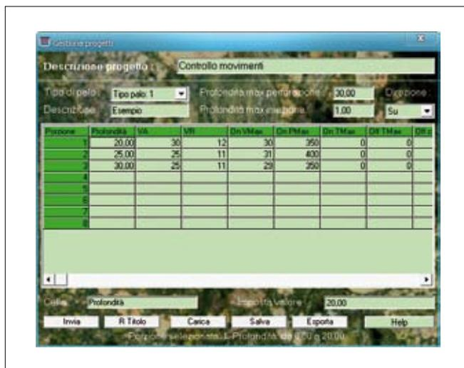
Attraverso il software JET S 104, progettato e prodotto da DAT instruments, è possibile impostare velocità di rotazione e traslazione differenti in diversi intervalli di profondità
