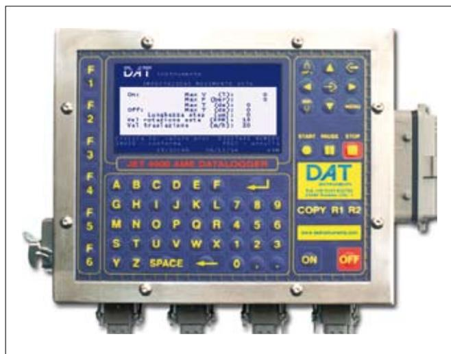
Un esempio di menù del datalogger durante un jet-grouting. I primi parametri sono dedicati agli step (tempi di stazionamento e movimento); gli ultimi rappresentano velocità di rotazione e di traslazione dell'asta
