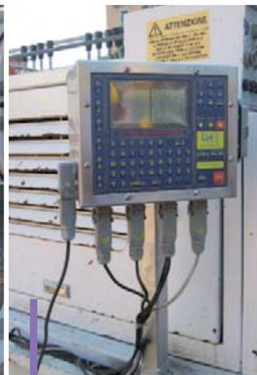
Il JET 4000 AME / J consente, attraverso la misurazione in tempo reale dei parametri di perforazione, di comprendere le caratteristiche geomeccaniche del terreno: la diagrafia restituita mette in evidenza le quote dei vari livelli stratigrafici.
