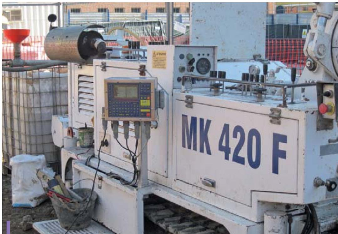
Il datalogger di DAT instruments è montato su un'unità di perforazione CMV MK 420 F.
