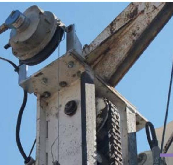
**Alcuni dei sensori applicati. Nell'ordine: il sensore di profondità con attacco a due punti; il sensore di pressione JET PRESS con salvamanometro JET P SEP / H e il sensore per la velocità di rotazione. La semplice sostituzione dei sensori permette al datalogger un utilizzo che spazia dal drilling al jet grouting, dal soil mixing al CFA.**
